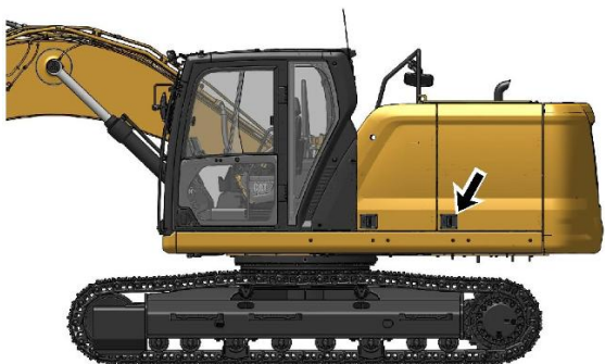
Рисунок 4 g06179792 Обеспечивает доступ к отверстию для отбора проб охлаждающей жидкости, сливному отверстию охлаждающей жидкости, сердцевинам маслоохладителей, силовым предохранителям, выключателю "массы" аккумуляторной батареи и баку охлаждающей жидкости.
