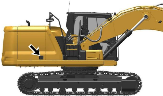
Рисунок 1 g06182545 Фильтр топливоподкачивающего насоса расположен за дверцей доступа на правой стороне машины.
